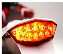
Модуляция заднего стоп сигнала привлекает внимание прикорнувших водителей, уменьшая шансы столкновения. Brake Light Pro от Healtech Electronics - самое совершенное устройство управления стоп сигналом на рынке. Блок предлагает 10 различных программ управления стоп сигналом, может работать со светодиодными лампами, ксеноновыми лампами и лампами накаливания максимальной мощностью 120 Вт.
