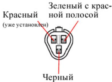
6. Вставьте два вытянутых с отцовской части разъема датчика передачи (из шага 4) провода в **большой, 3x контактный** разъем белого цвета из набора. При усадке контакт должен щелкнуть. Внизу показана схема подключения. Разъем лежит защелкой вверху. Провода вставляются сзади разъема.
