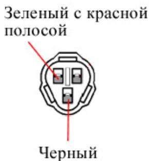
7. Соедините 4x контактные разъемы датчика передачи.
