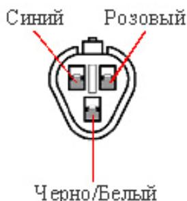
7. Вставьте три материнских контакта в **больший, 3х контактный** материнский разъем белого цвета из набора. При усадке контакт должен щелкнуть. Внизу показана схема подключения. Разъем лежит защелкой кверху. Провода вставляются сзади разъема.
