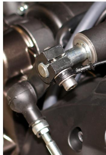
7. **Аккуратно проложите провод датчика к QSE, затем подключите его к 2x контактному разъему.**
