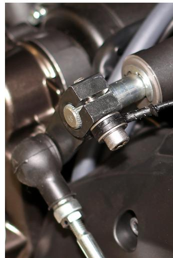
7. **Аккуратно проложите провод датчика к QSE, затем подключите его к 2х контактному разъему.**
