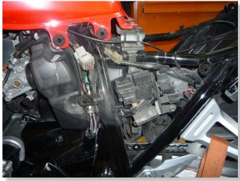
PLUG ATRE CONNECTORS IN-LINE WITH THE GEAR POSITION SENSOR CONNECTORS.
