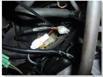
CONNECT ATRE RED WIRE TO ORANGE/GREEN WIRE OF REAR BRAKE SWITCH CONNECTOR.
