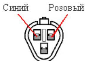
8. Вставьте два отцовских (из шага 6) контакта **больший, 3х контактный** материнский разъем белого цвета из набора. При усадке контакт должен щелкнуть. Внизу показана схема подключения. Разъем лежит защелкой кверху. Провода вставляются сзади разъема.
