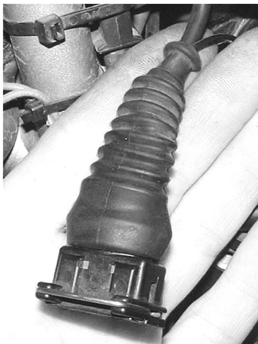
7. Соберите разомкнутый контакт Датчика Положения Коленвала и закрепите его к раме с помощью хомута.
