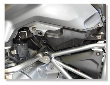
CONNECT THE QSH CONNECTORS IN-LINE WITH THE FUEL INJECTOR CONNECTORS.
