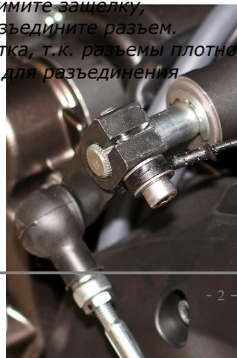
Ориентация датчика – не имеет значения. После установки - убедитесь, что датчик не цепляется за детали при переключении вверх и вниз. Затяните болт на **7-10 Нм**. Это обычный момент для болта М6 – не перетягивайте болт! После или во время затяжки – не проворачивайте датчик – так вы можете его повредить. Если шайба утеряна, можно использовать любую, под болт М6, диаметром не менее 14мм. Поверхность шайбы должна быть гладкой и ровной, чтоб распределять нагрузку равномерно.
