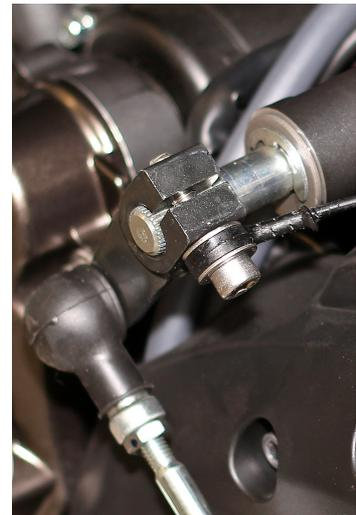
7. **Аккуратно проложите провод датчика к QSE, затем подключите его к 2х контактному разъему.**
