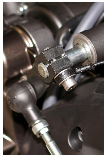
7. **Аккуратно проложите провод датчика к QSE, затем подключите его к 2х контактному разъёму.**
