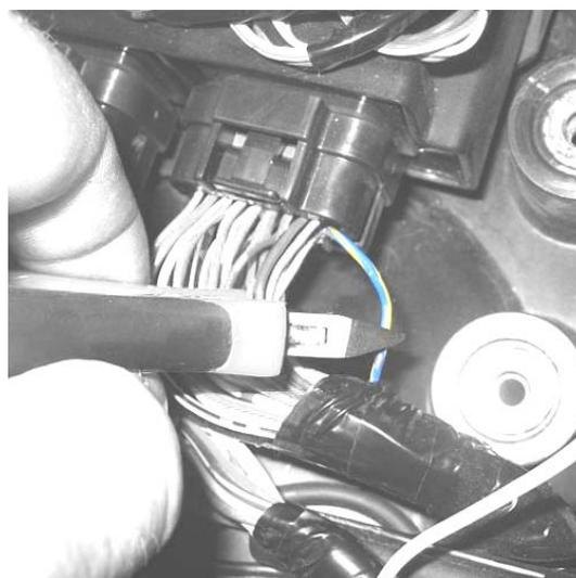
7. Припаяйте Белый провод SH к Сине/Желтому проводу ECU со стороны разъема, предварительно зачистив провод. Изолируйте соединение с помощью термоусадки или изоленты.
