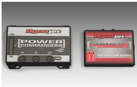
Power Commander это блок управления инжектором, предназначенный для точной настройки топливных карт под ваш мотоцикл. Аналогом PowerCommander для Suzuki является блок Healtech Electronics - [FIT](#), обладающий теми же характеристиками что и Power Commander. [FIT](#) подключается в порт расширения блока управления, что позволяет использовать один блок на всех мотоциклах Сузуки и использовать встроенные функции блока управления, такие как Acceleration Pump.
