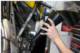
В большинство современных 4х тактных мотоциклов заливается синтетическое мотоциклетное масло. Мотоциклетное масло отличается от автомобильного присадками, необходимыми для работы сцепления. В отличие от сухого автомобильного сцепления, сцепление мотоцикла погружено в моторное масло. Если залить автомобильное масло в мотоциклетный мотор то корзина сцепления начнет проскальзывать, что приведет к преждевременному износу дисков сцепления.
