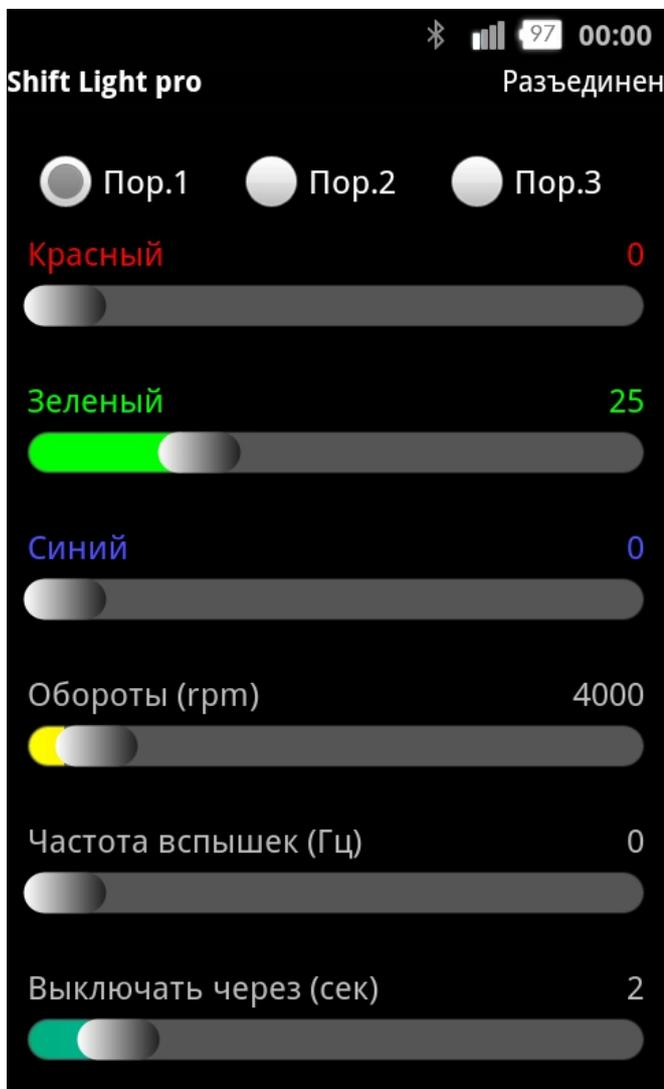
Нажав на Меню мы попадаем в экран дополнительных возможностями, отсюда же мы можем подключиться к SLP. Соединение защищено ПИН кодом, ПИН код по-умолчанию можно найти в детальной инструкции по установке и настройке. В настройках (Settings) можно изменить язык на Русский.
