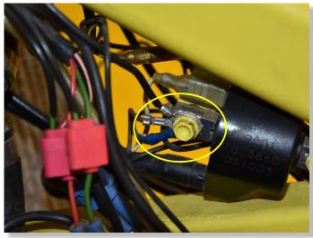
CONNECT THE QSH RED WIRE TO THE BATTERY POSITIVE TERMINAL VIA AN ON/OFF SWITCH.
