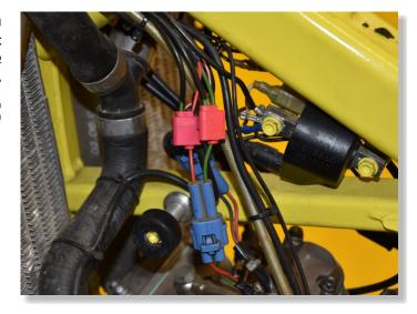
CONNECT THE QSH BLACK WIRE TERMINAL TO THE IGNITION COIL GROUND TERMINAL.
