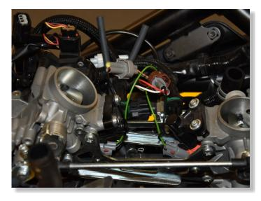
CONNECT THE QSH BLACK WIRE TERMINAL TO THE BATTERY NEGATIVE TERMINAL.
